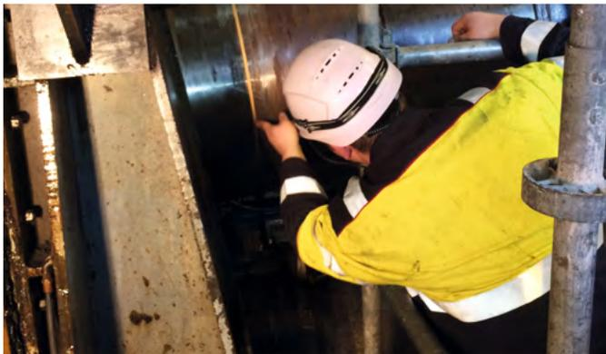
Anbringung der Telemetrieinheit
