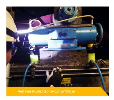
Selbst Komponenten von höchster Qualität funktionieren nicht ordnungsgemäß, wenn sie nicht korrekt installiert und justiert wurden. Der PARALIGN Service von PRÜFTECHNIK verwendet ein einzigartiges Messgerät mit drei orthogonal angeordneten Ringlasern zur schnellen Messung der Walzen. Mit der Reporting-Funktion können Korrekturen sofort nach der Messung der zweiten Walze gestartet werden.
