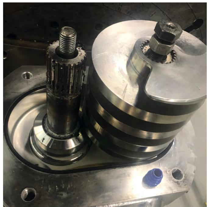
Lagerschaden an einer Schneckenpumpe
