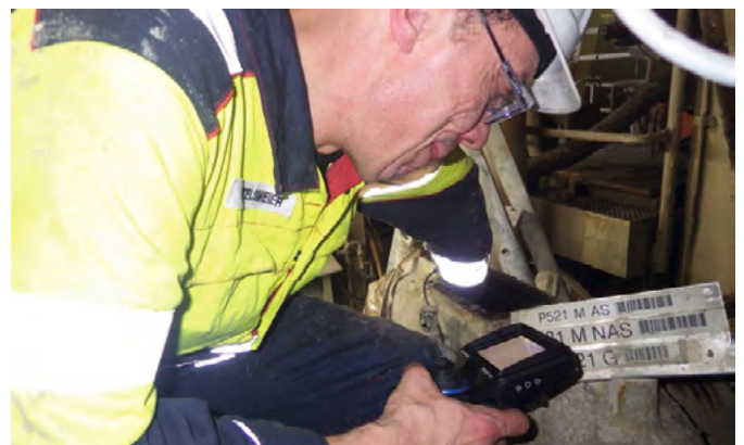
Endoskopieuntersuchung eines Getriebes
